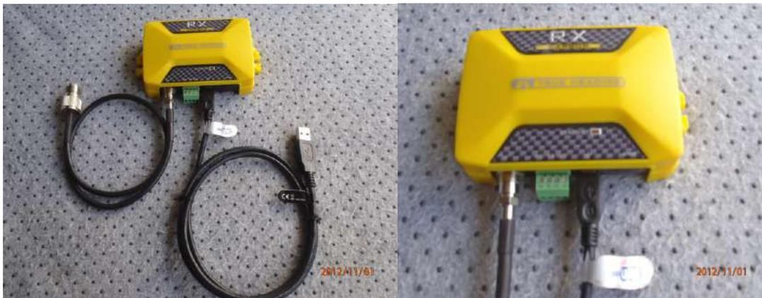
左側ケーブル(同軸): アンテナにつなぎます(M型コネクタ)
