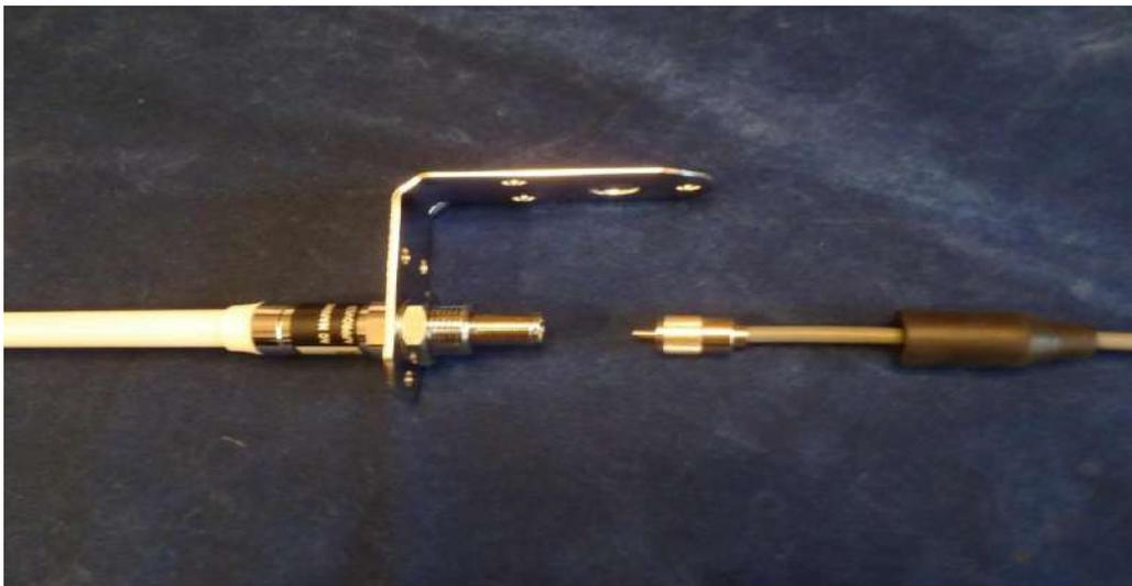
屋外の同軸ケーブルのコネクタは防水するため同梱のゴムパッキングを装着し自己融着テープで確実にシールしてください。写真(右)のように、ケーブルに小さなループを付ければ、メンテナンスが楽です。取付金具が付いています。
